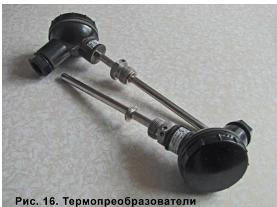
Рис. 16. Термопреобразователи
