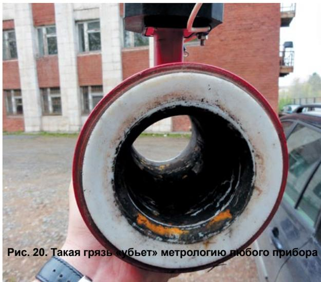
Рис. 20. Такая грязь «убьет» метрологию любого прибора
