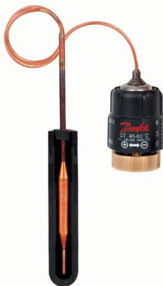
Рис. 1. АВ-QT (автоматический балансировочный клапан АВ-QM с термoeлементом QT) – устройство “2 в 1”, выполняющее одновременно автоматическую балансировку и термостатирование стояка
